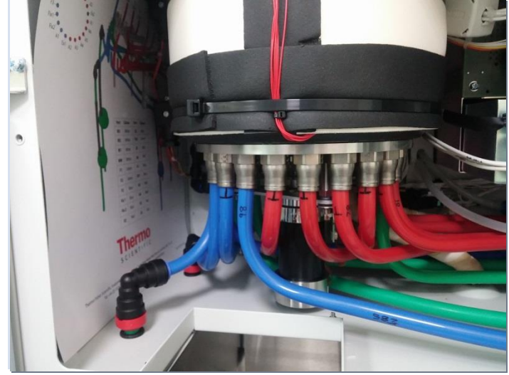
每個藥液缸採獨立式管路設計,減低堵管風險
